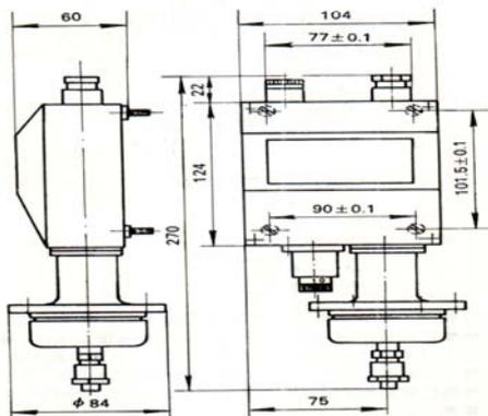
序号 1.2 规格的压力控制器
