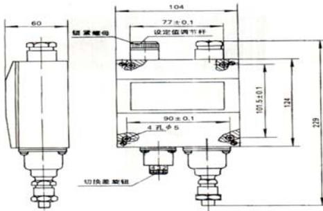
序号 3~11 规格的压力控制器
